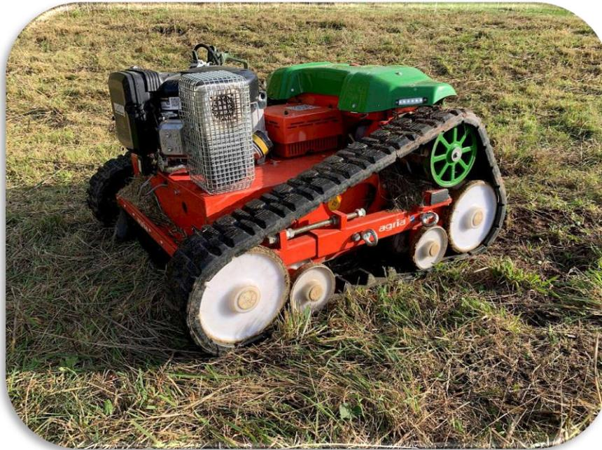
Für die Mäharbeiten des Bauhofs wurde eine ferngesteuerte Mähraupe angeschafft, die den 20 Jahre alten Böschungsmäher entlasten und später ersetzen soll. Durch die Fernsteuerung ist es nicht mehr nötig, selbst auf dem Gerät zu sitzen, was die Unfallgefahr reduziert.
