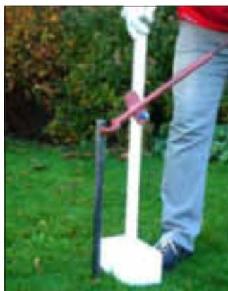
Ziehvorgang des Bohrstockes.
